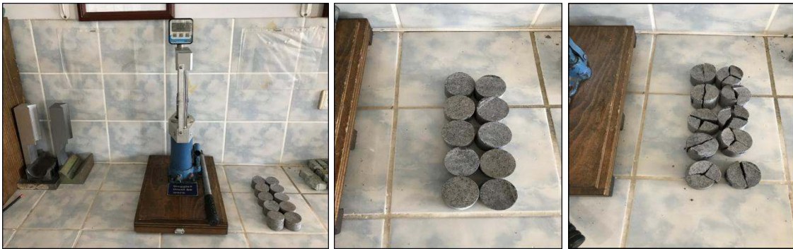
Şekil 2.6. Nokta yük deneyinin gerçekleştirilmesi
