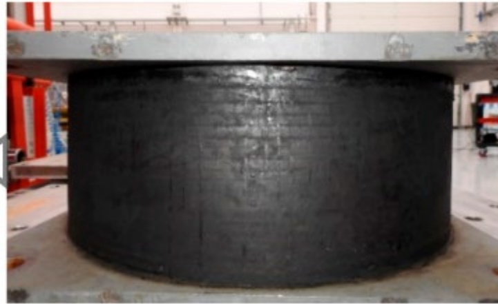
Şekil 24. Kurşun çekirdekli kauçuk örneği (Yasar ve diğ. 2023)
