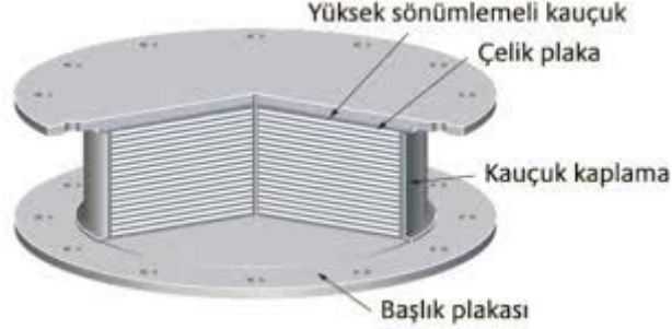
Şekil 26. Yüksek sönümlü kauçuk mesnet örneği (Çavdar ve Yıldız 2023)
