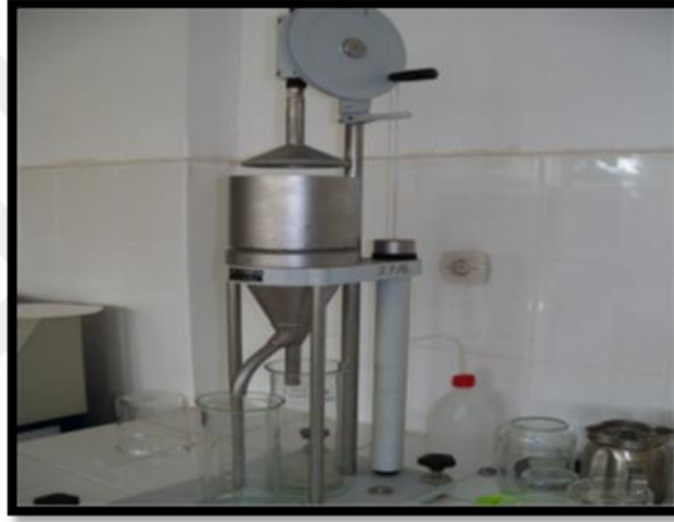
Şekil 3.8: Schopper Riegler test cihazı (Fotoğraf: Aysun MUSTAK, 2018).
