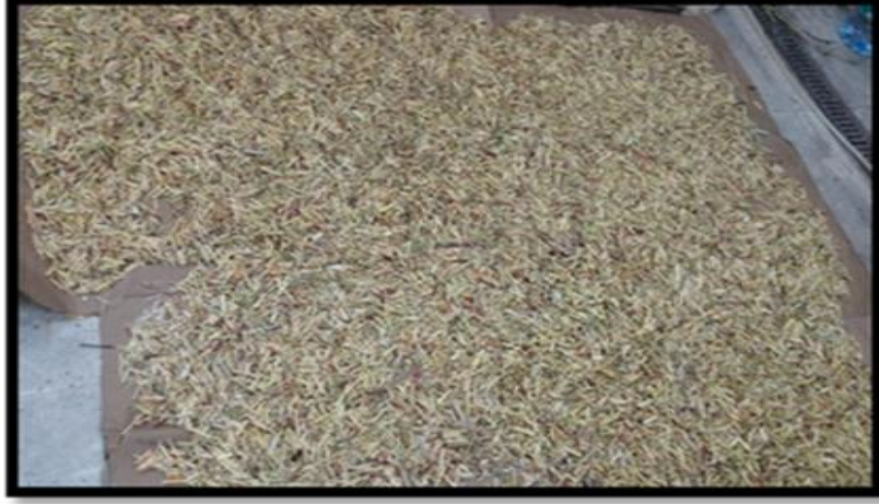
Şekil 3.2: Sorgum saplarından 3 cm uzunluğunda kesilmiş örnekler (Fotoğraf: Aysun MUSTAK, 2017).
