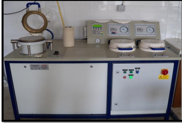
Şekil 3.9: Rapid Köthen kağıt makinası (Fotoğraf: Aysun MUSTAK, 2018).
