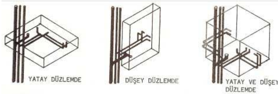
Şekil 3.15 Tesisat sistemlerinin yatay ve düşey düzlemlerde dağılım seçenekleri (İlhan,2008)
