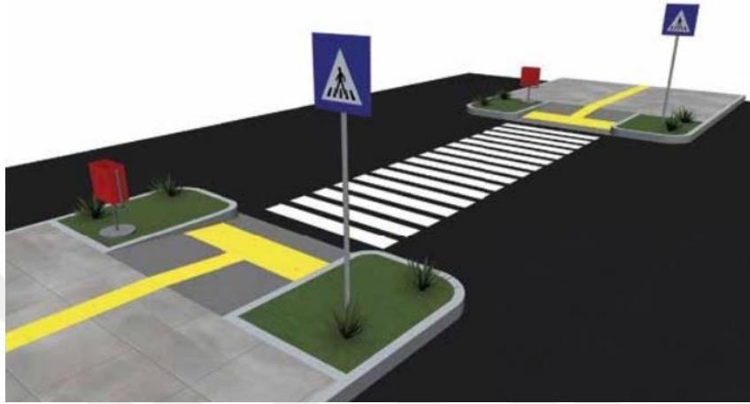
Görsel 11: Görme Engellilere Yönelik Hissedilebilir Yüzey Uygulaması
