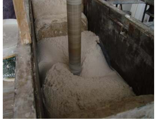
Resim 4.25. Söve Harcının, Harç Kaplama Kazanındaki Görüntüsü [34].
