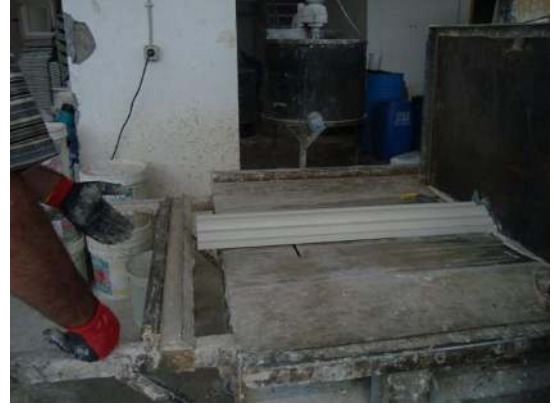
Resim 4.27. Sıvama İle Sıvanan EPS nin Makineden Çıkışı [34].
