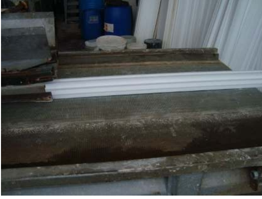
Resim 4.26. Kesilmiş EPS nin Sıvanmak Üzere Kaplama Kazanına Gönderilmesi [34].
