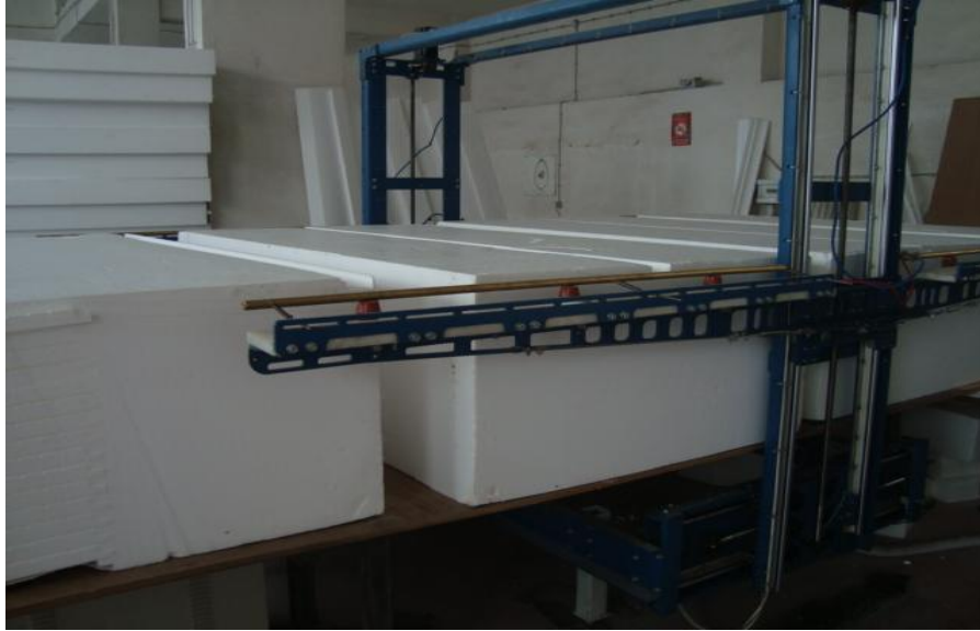
Resim 3.4. CNC Makinelerinde EPS den Söve kesimi [34].
