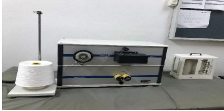
Şekil 3.3. Tüylülük ölçüm cihazı -Zweigle (G567)
