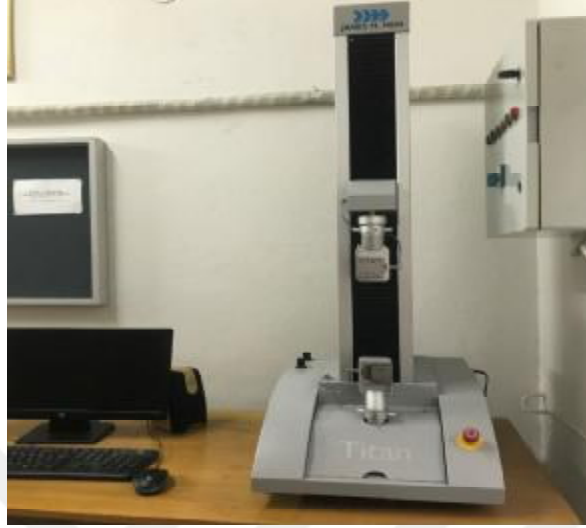
Şekil 3.4. Mukavemet ölçüm cihazı(Titan-Universal Strenght Tester by James H.Heal Co.Ltd.)
