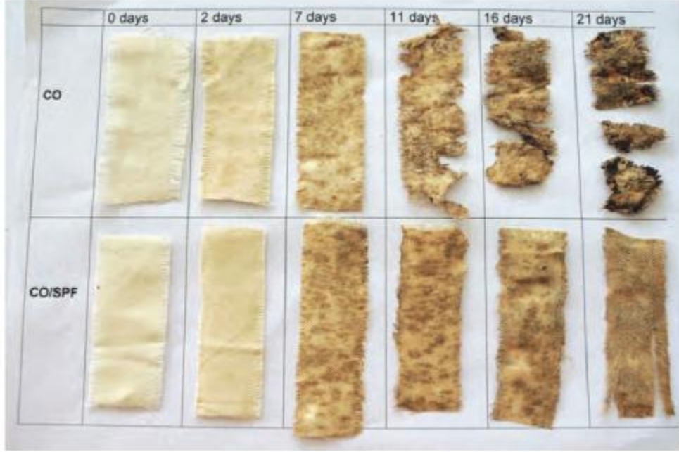
Şekil 1.2. Soya-pamuk karışımı ve pamuk kumaşların 0-21 gün toprakta bekletilmesi sonundaki görüntüsü (Rijavec ve Zuplin, 2011)
