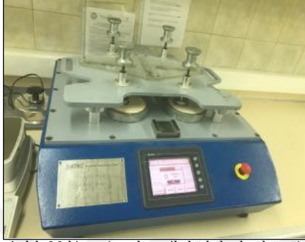
Şekil 3.21. Martindale Makinası (aşındırma ile kütle kaybı ölçümü)
