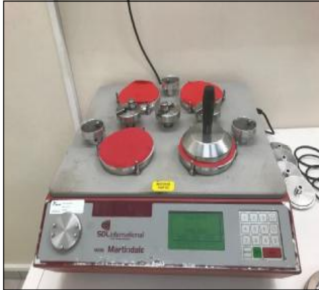
Şekil 3.22.Martindale makinası(yüzey tüyenmesi ölçümü)
