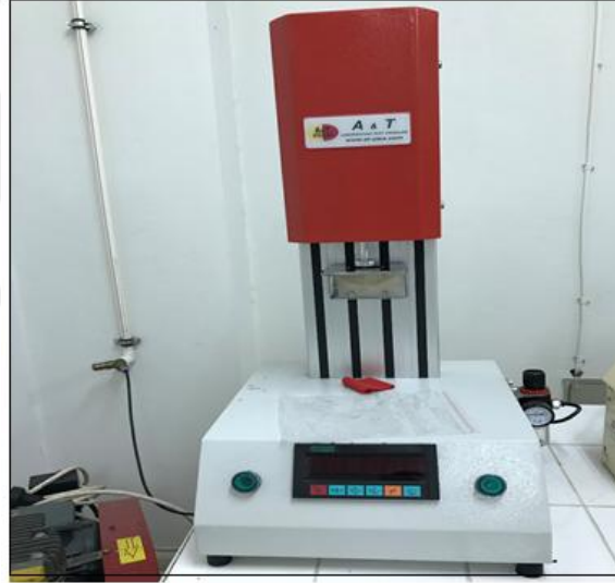
Şekil 3.20. Dairesel eğilme dayanımı (Stiffness) ölçüm cihazı
