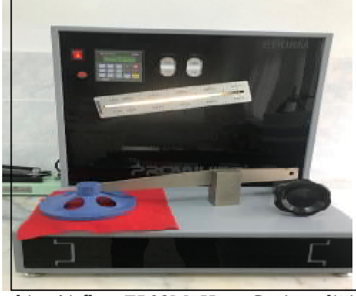
Şekil 3.18. Prowhite Airflow EP08M- Hava Geçirgenliği Test Cihazı
