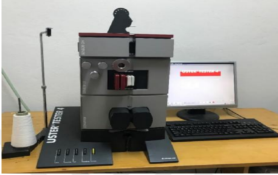
Şekil 3.5. Düzgünlük ölçüm cihazı-Uster Tester 4-S
