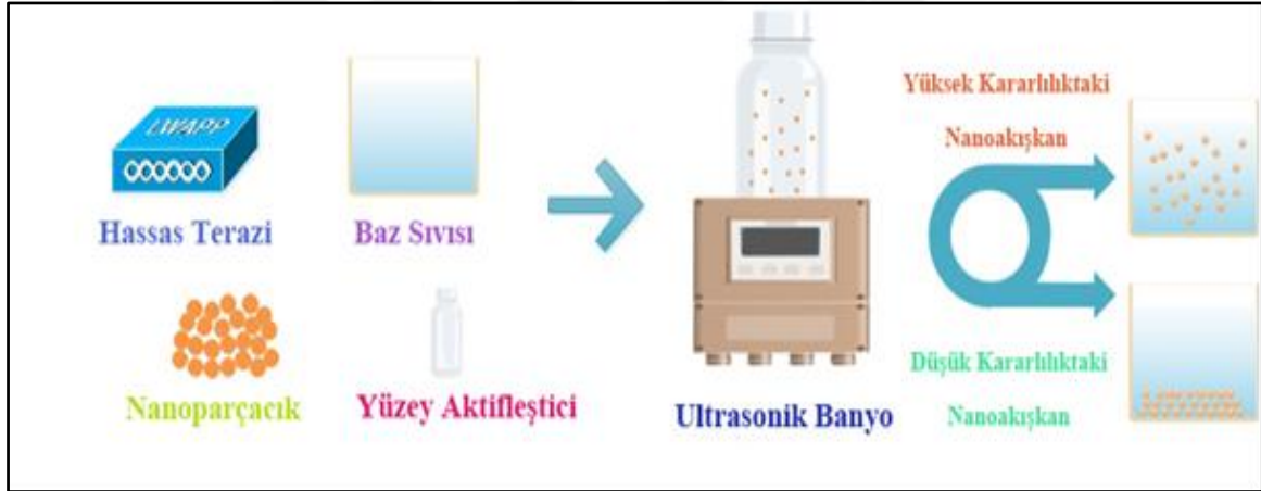
Şekil 5.3. Nanoakışkan hazırlamada iki adımlı yönteme başvurulması
