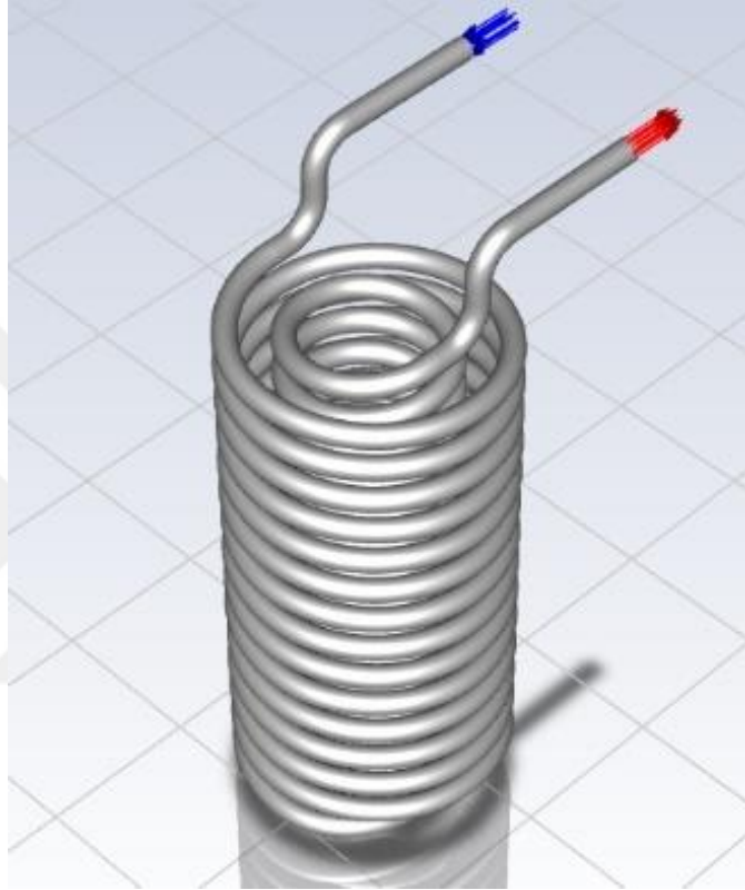
Şekil 4.8. CFD Modeli, giriş ve çıkış yüzleri
