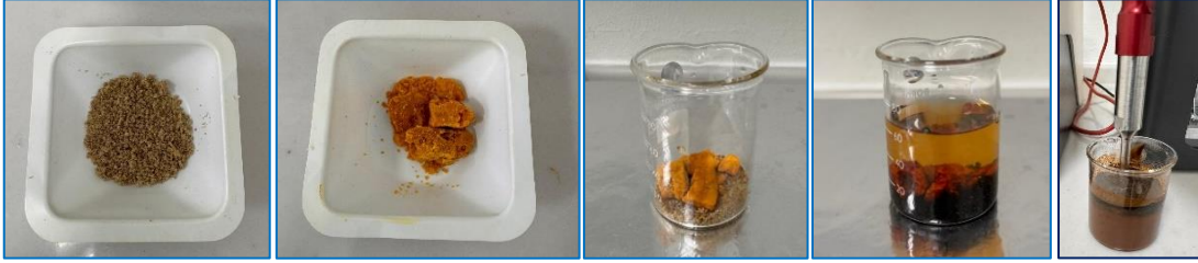
Şekil 3.3. Fe_3O_4 nanopartiküllerin üretim aşamaları
