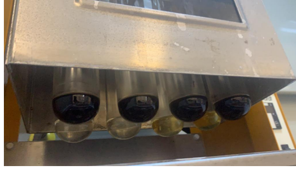
Şekil 3.8. Kjeldahl cihazında arkada tamamen yanıp berraklaşan ve öndeki yanması tamamlanmamış, koyu renkli örnekler
