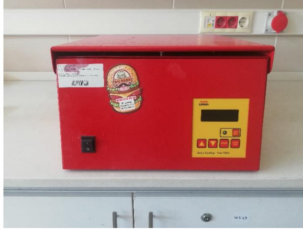
Resim 3.12. Gerber santrifüj cihazı
