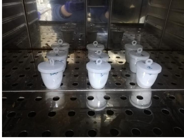
Resim 3.14. Örneklerin etüvde kurutulması
