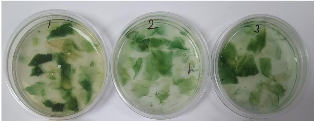
Şekil 3.5. Farklı oranlarda glutaraldehit içeren Spirulina ilave edilmiş hidrojeller
