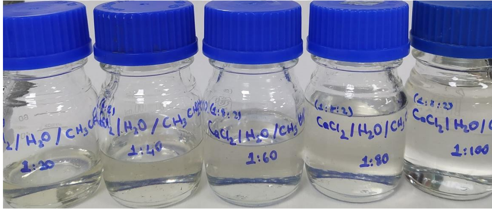
Şekil 3.1. Farklı oranlarda Ajisawa Reaktifi ile çözülmüş fibroin örnekleri
