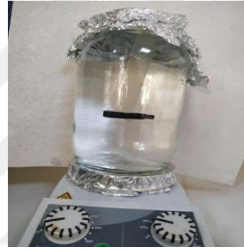
Şekil 2.4. İpek fibroini çözeltisinden diyaliz işlemi ile \text{CaCl}_2 'nin (Sigma-Aldrich) uzaklaştırılması
