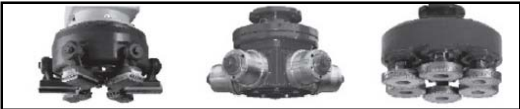
Şekil 1.5. Porselen karo iri öğütme / parlatma işlemlerinde kullanılan farklı kafa türleri (tanjant, silindirik ve uydu) [8]
