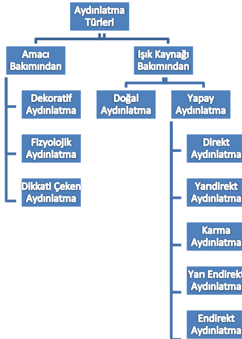
Şekil 2. 4 Aydınlatma türleri şeması (Şahin 2014).
