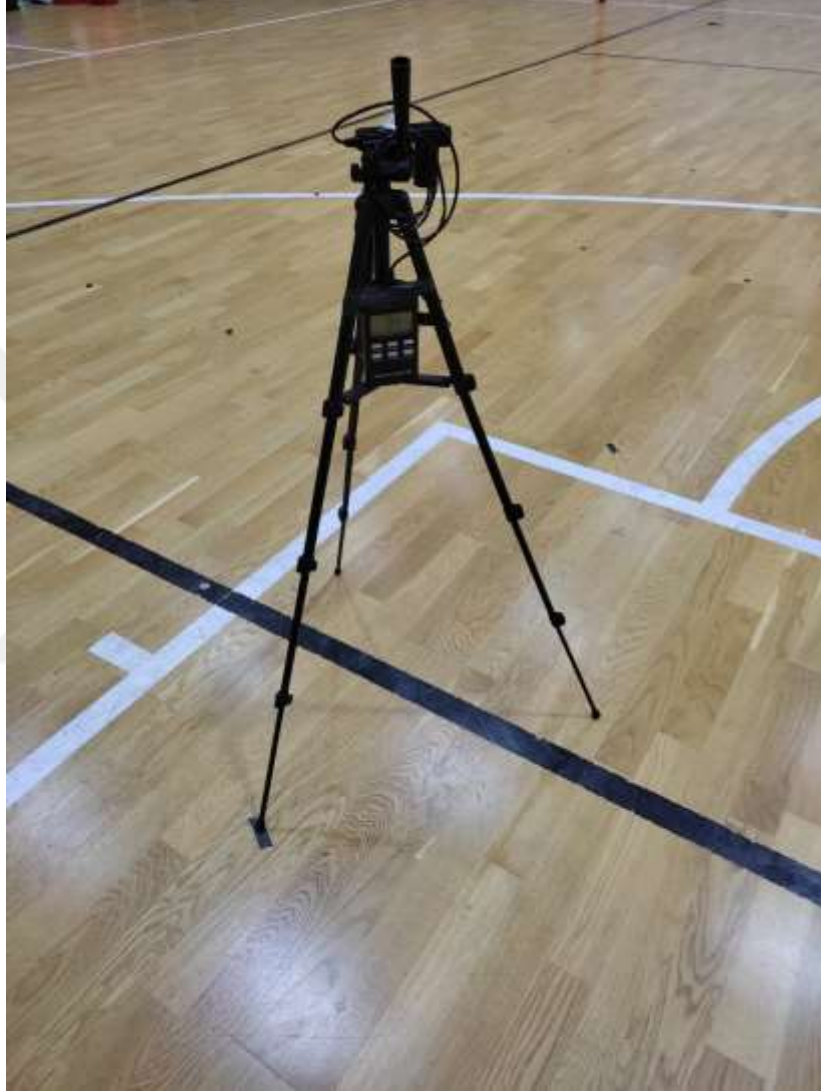
Şekil 4. 7 Ölçümlerin yapıldığı lüminansmetre düzeneği.
