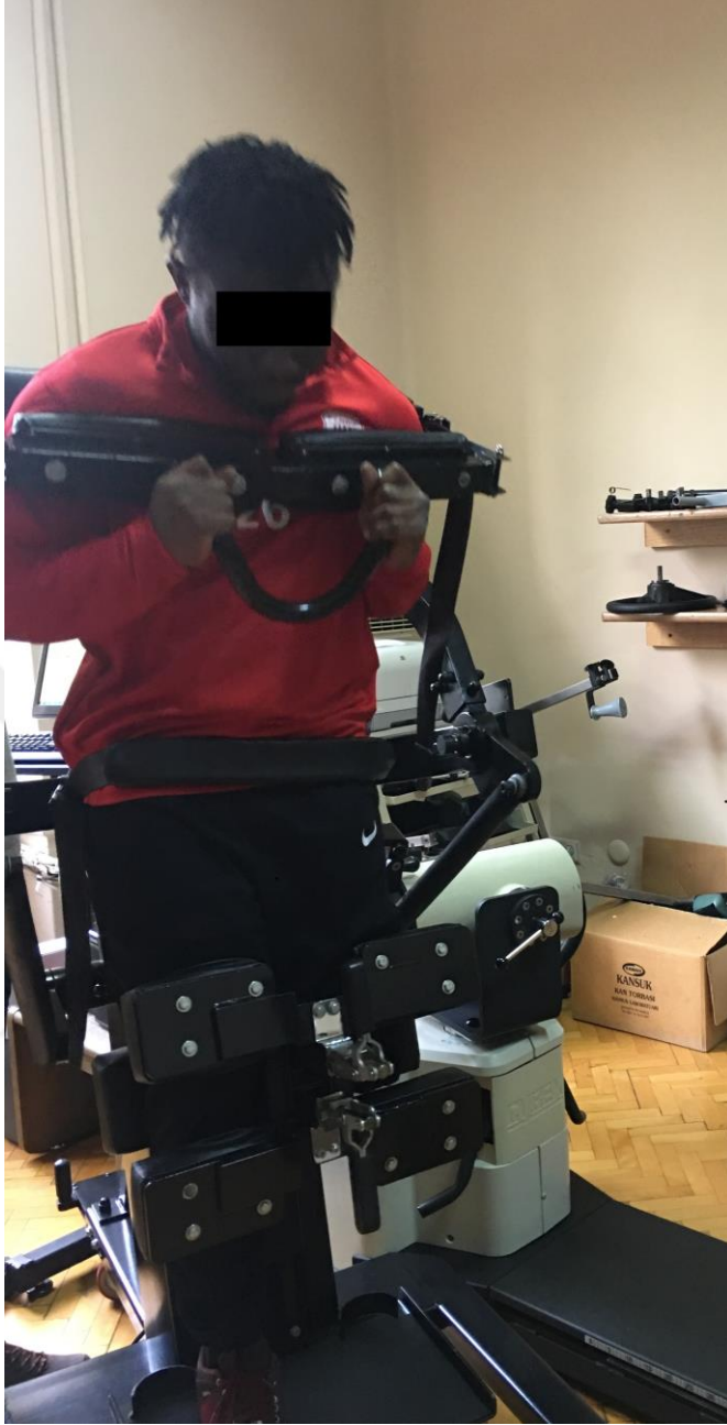
Şekil 3-5: İzometrik dinamometre ile gövde kas gücü ölçümü
