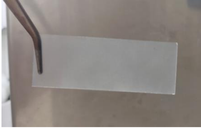
Şekil 4. 6. Cam üzerine oluşturulan \text{TiO}_2 ince tabaka.
