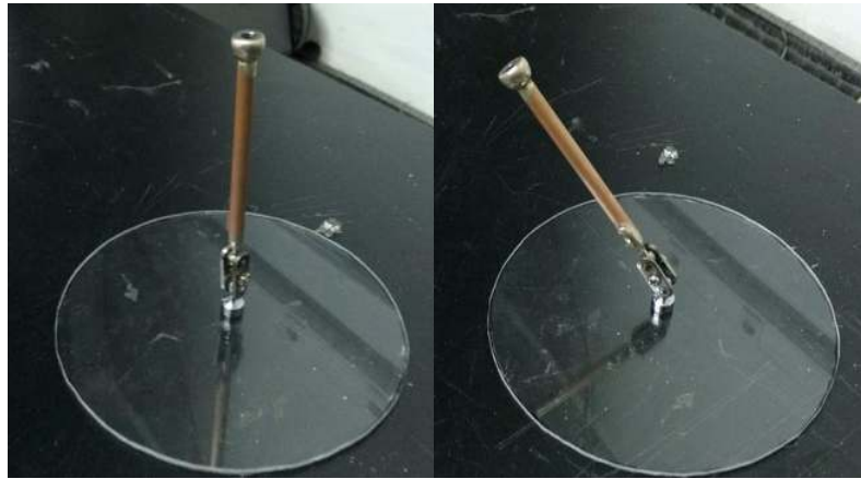
Şekil 4. 12 Küresel mafsallı monte edilmiş etki yüzeyi
