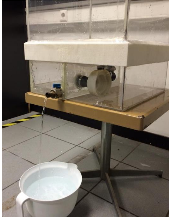
Şekil 4. 10 Pompa ve küresel vananın montajı
