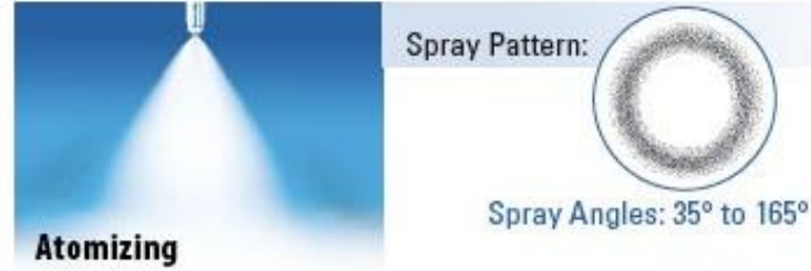
Şekil 2. 23 Atomize püskürtme türü [11]
