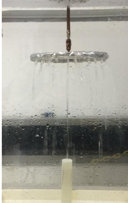
Şekil 5. 1 Su jetinin etki yüzeyine çarpması (etki yüzeyinin açısı 90°'dir.)
