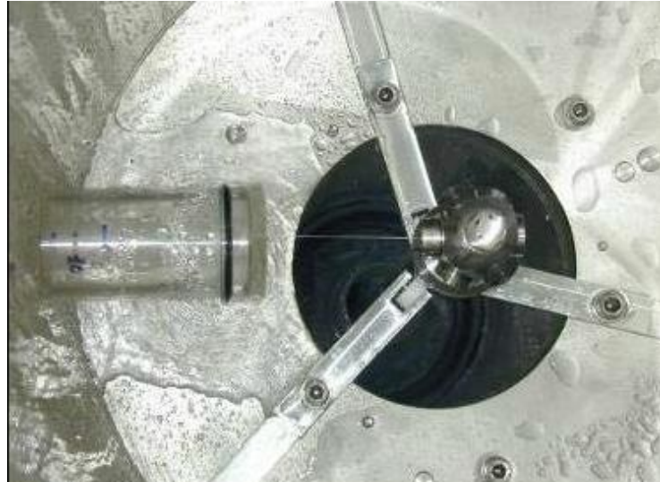
Şekil 2. 39 Su jeti test düzeneği [23]
