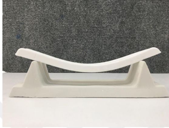
Şekil 2.20. Deformasyon ölçümleri için pişirilmiş numuneler
