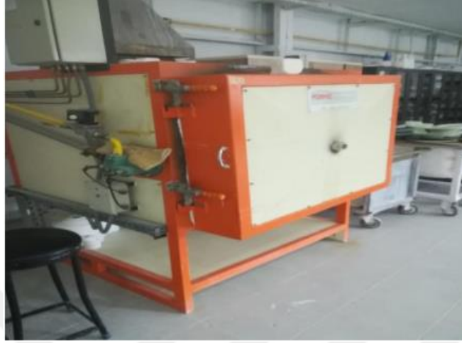
Şekil 4.1. Gazlı sinterleme fırını.
