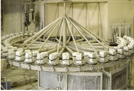
Şekil 2.10. Döküm şekillendirme a) Alçı döküm kalıpları b) Basınçlı döküm makinesi
