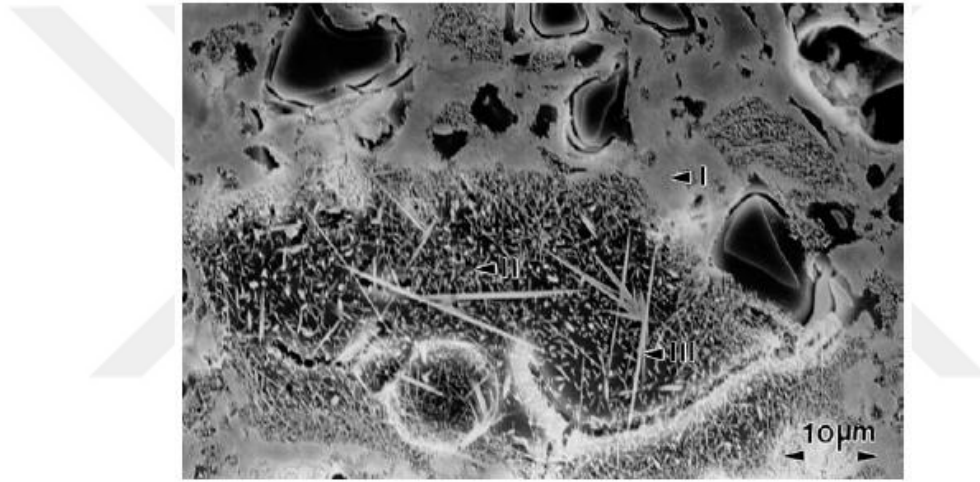
Şekil 2.19. Müllitin 3 tipini içeren porseleninin ikincil elektron SEM görüntüsü
