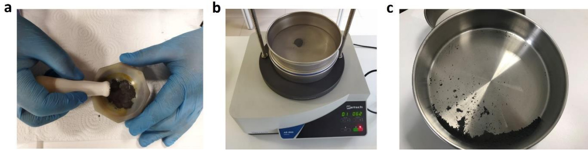
Şekil 26. Sinterleme sonrası tozların parçalanması ve elenmesi.
