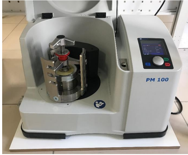
Şekil 22. Restch PM 100 marka bilyalı öğütme cihazı.
