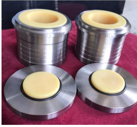
Şekil 20. Bilyalı öğütme işleminde kullanılan paslanmaz çelik dış jar ve kestamit iç hazne.
