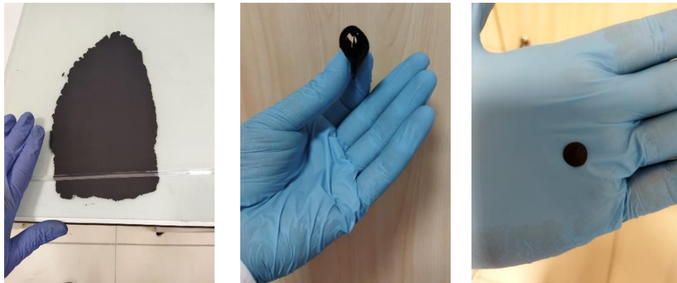
Şekil 32. Kâğıt formunda aktif karbon elektrot.
