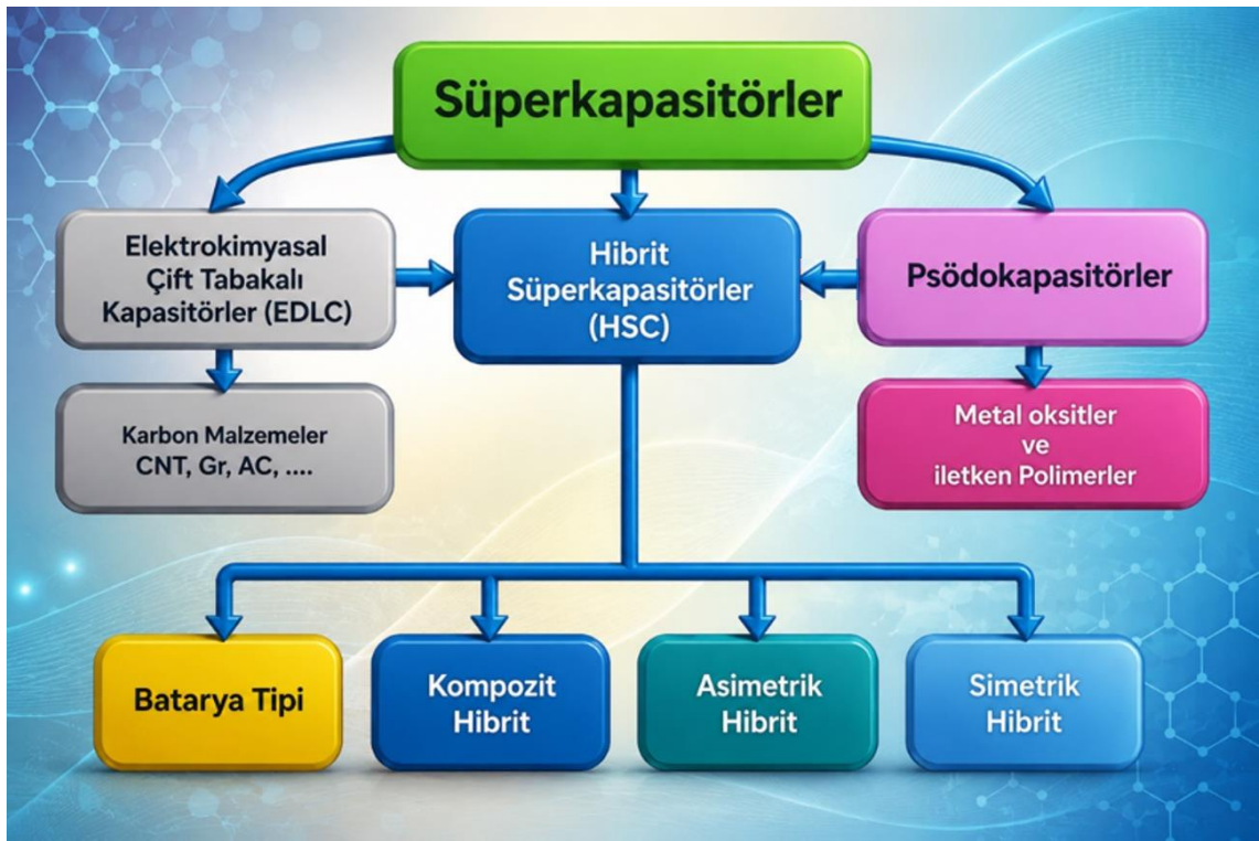
Şekil 11. Süperkapasitörlerin yük depolama mekanizmalarına göre sınıflandırılması.
