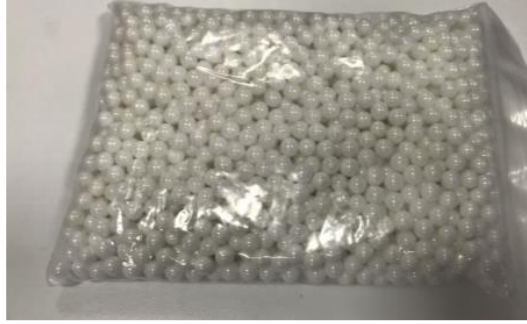
Şekil 19. Toz karıştırma işleminde kullanılan 5 mm çapındaki itriya stabilize zirkonya (YSZ) bilyeler.
