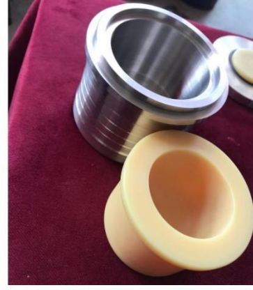
Şekil 20. Bilyalı öğütme işleminde kullanılan paslanmaz çelik dış jar ve kestamit iç hazne.
