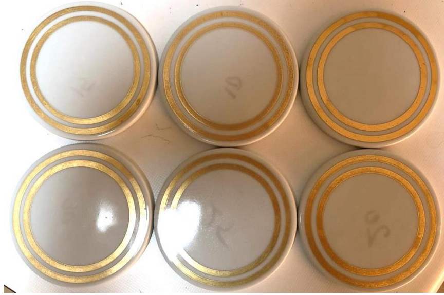
Şekil 5.3. Dekorlama sonrası üzerine sırlama yapılmış numuneler
