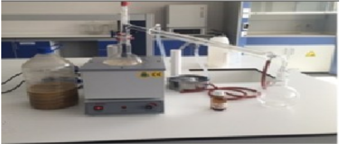
Şekil 2.13. Deneyde kullanılan damıtma düzeneği
