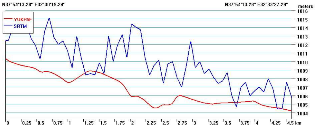
Şekil 4.30 Yerleşim yerinde SRTM ile Topografik harita arasındaki farklar
