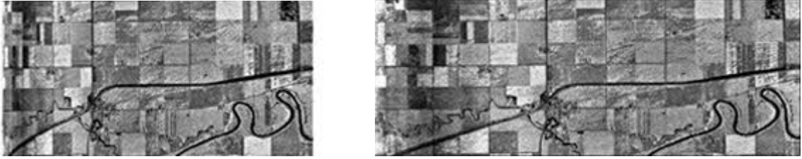
Şekil 3.18 Eğik mesafe ölçek bozulması radar görüntüsü [7].
