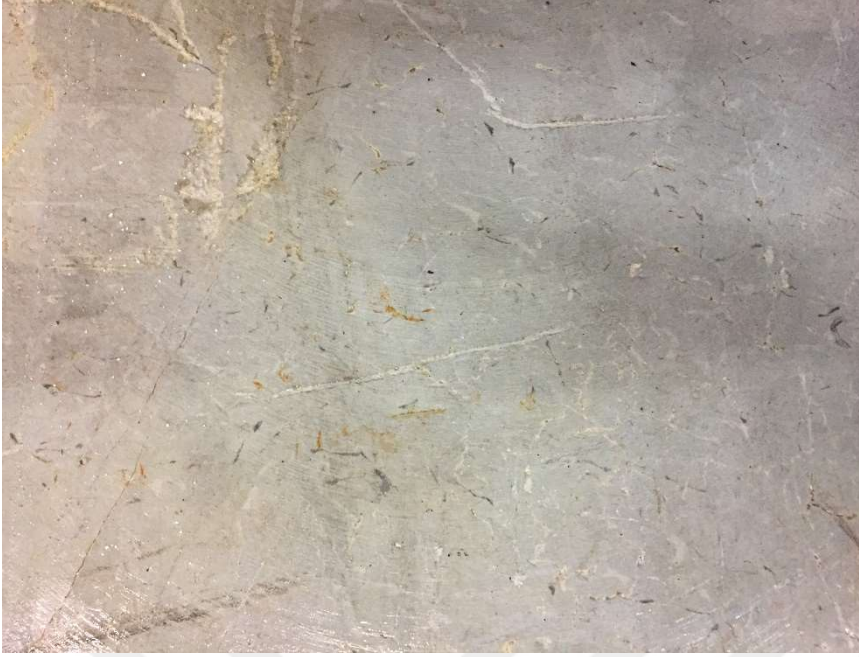
Şekil 3.5. Deneylerde kullanılan kireçtaşı (Sivas Antik Bej)
