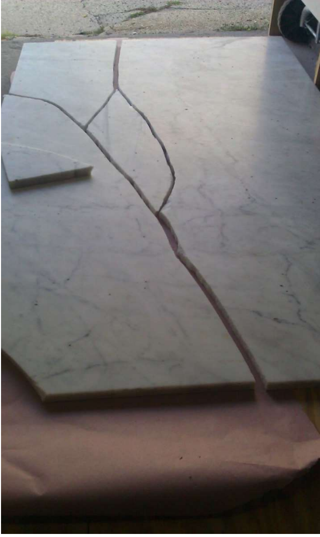
Şekil 2.9. Üretimi esnasında kırılan plaka [40]
