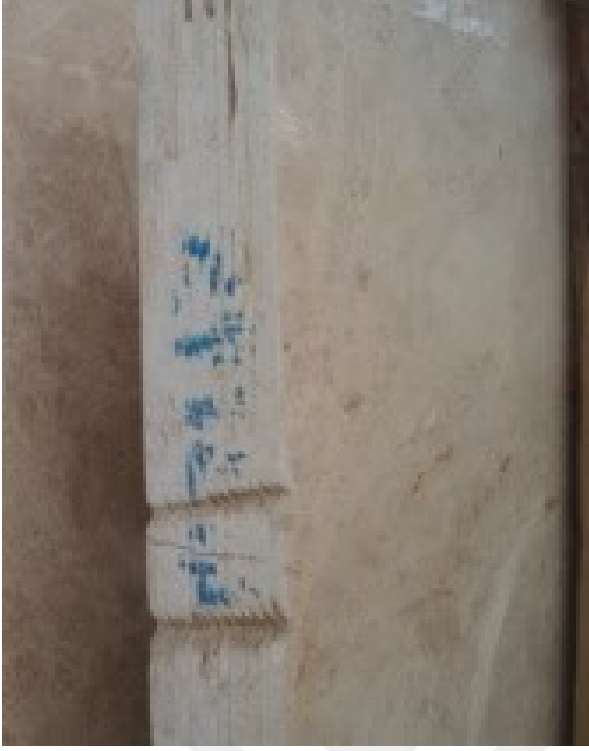
Şekil 2.7. Üretilen plakada testere izleri [39]
