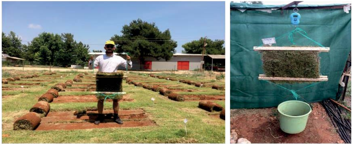
Şekil 3.19. Rulo çimlerin kopmaya karşı dayanımları test edilirken
