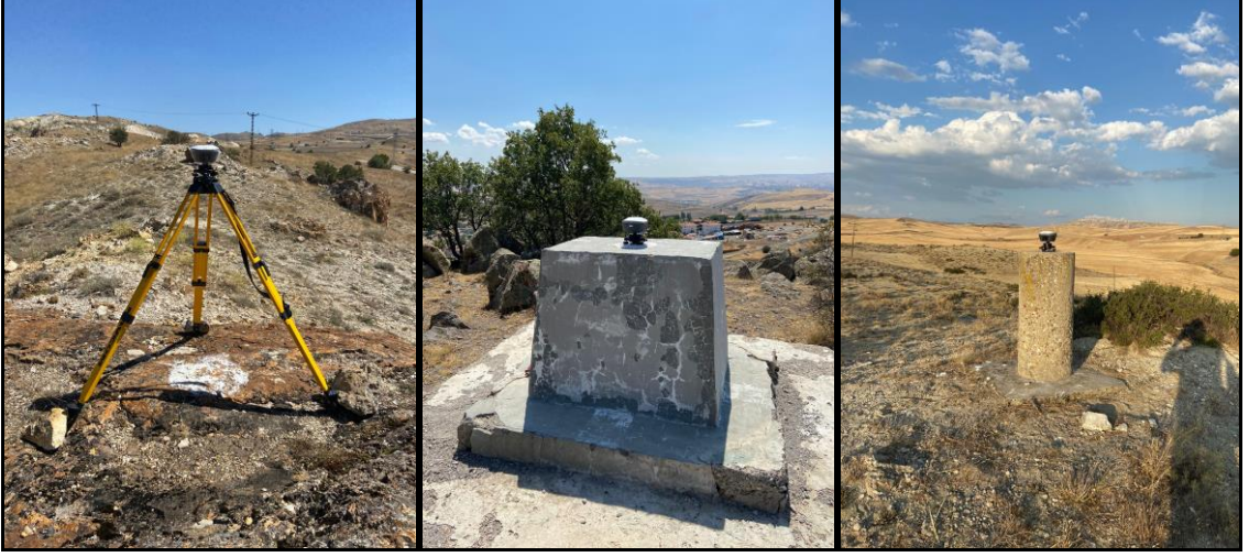
Şekil 3.12. Arazi Çalışmasına Ait Eğik Tripod ve Düşey Tribrach Kurulumu
