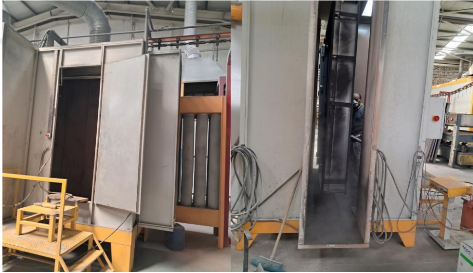
Şekil 4.8. Elektrostatik Toz Boya Süreci
