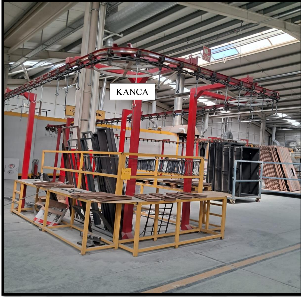
Şekil 4.6. Elektrostatik Toz Boya Prosesi
