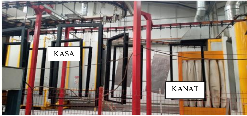
Şekil 4.9. Elektrostatik Toz Boya Prosesi Konveyör Hattı
