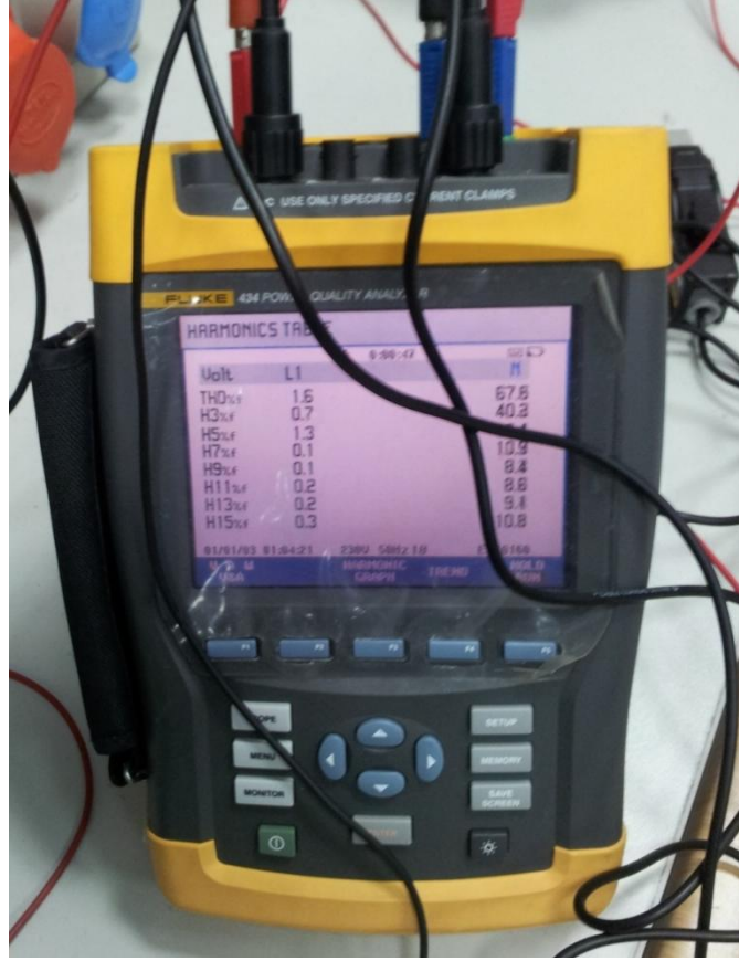
Şekil 7. 3 Ölçümlerin yapıldığı güç kalitesi ve enerji analizörü
