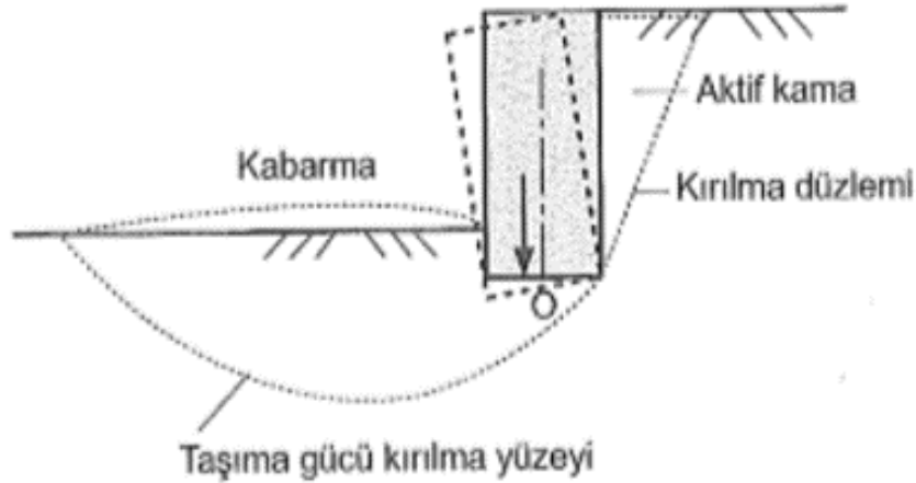
Şekil 22. Taşıma gücü göçmesi (Uzuner, 2007)
