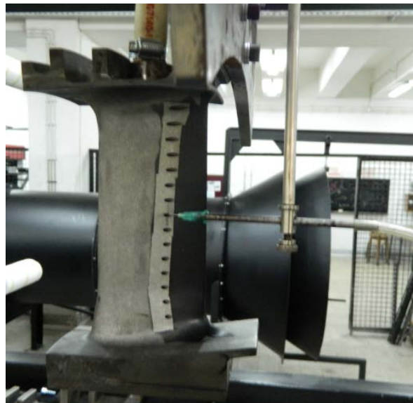
Şekil 4.15 : Hız profili ölçümü.
