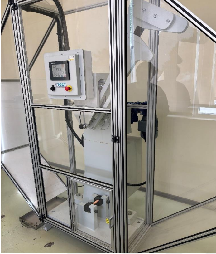
Şekil 5.4 Çentik darbe test cihazı
