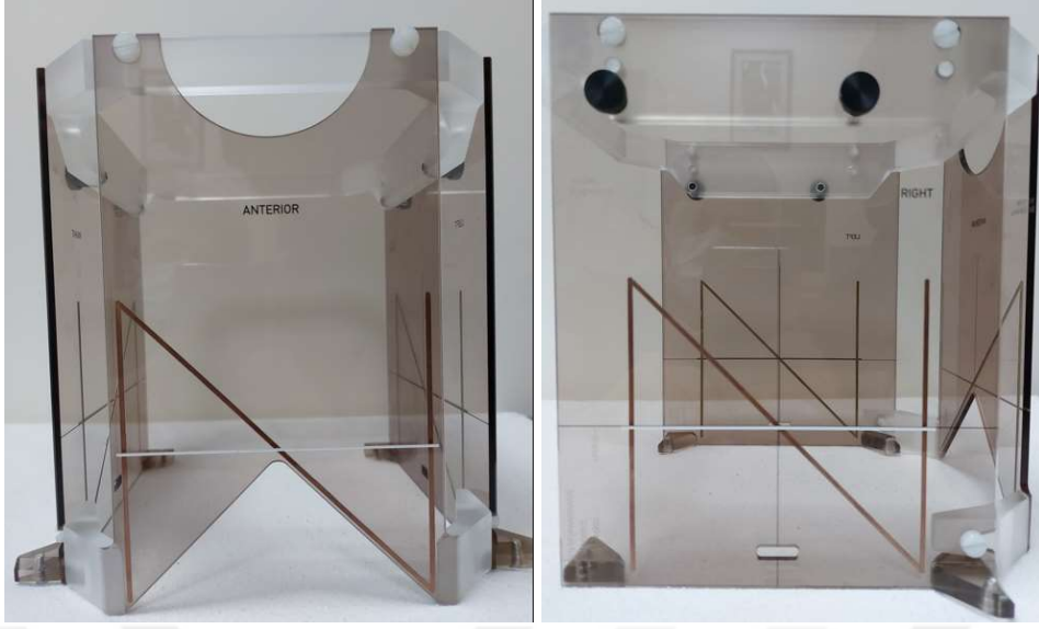
Şekil 3.3. MR uyumlu adaptör, anterior-posterior ve lateralden görünümü ile radyolojik görüntülere yansıyan N şekilli plaklar
