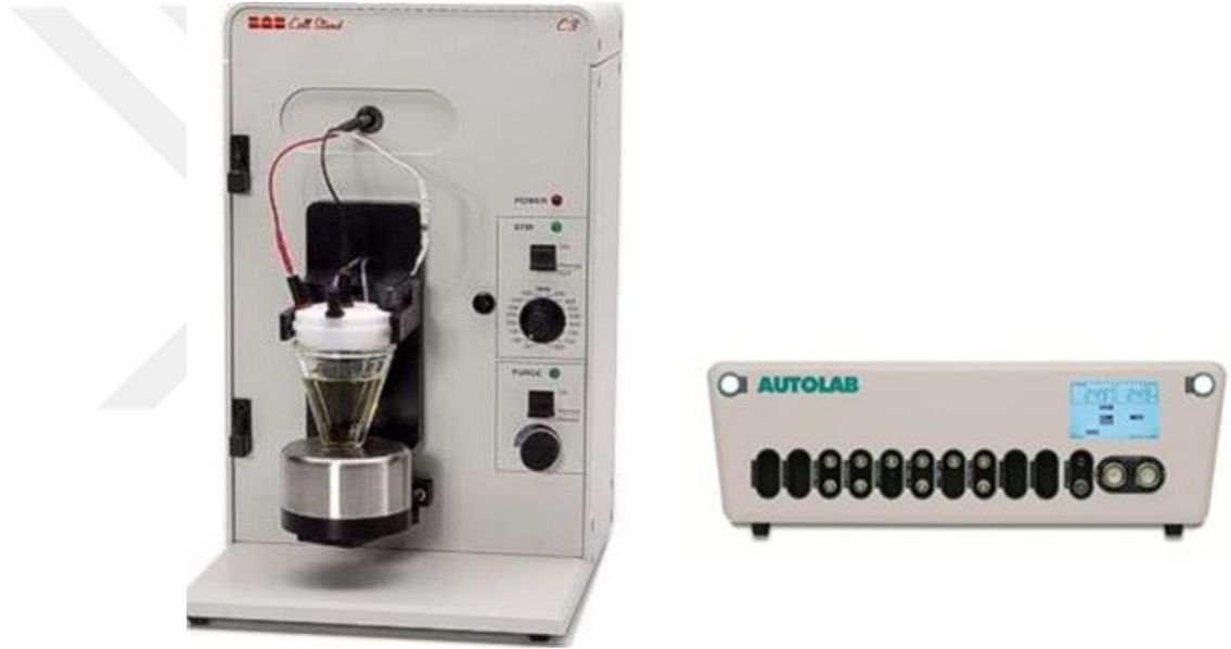
Şekil 3. 1. PGSTAT128N potansiyostat ve BASİ üçlü hücre cihazı.
