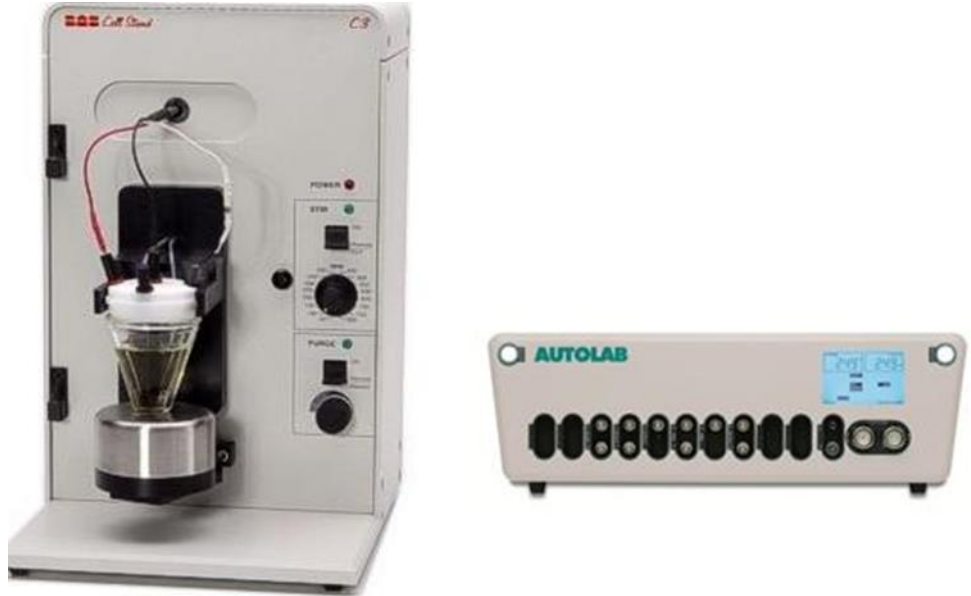
Şekil 3. 1. PGSTAT128N potansiyostat ve BASİ üçlü hücre cihazı.
