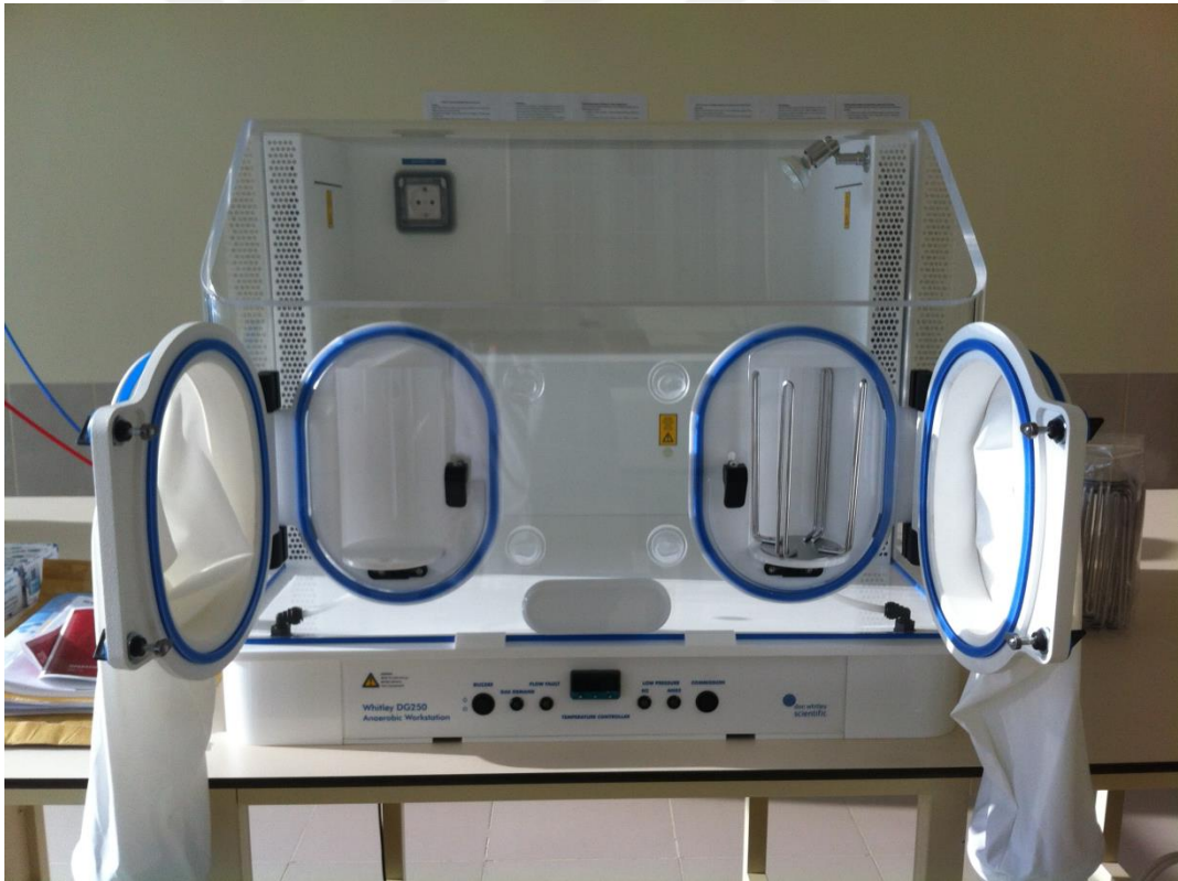
Şekil 3.5. Çalışmada kullanılan anaerobik kabin (Whitley DG250, Don Whitley, West Yorkshire, UK)
