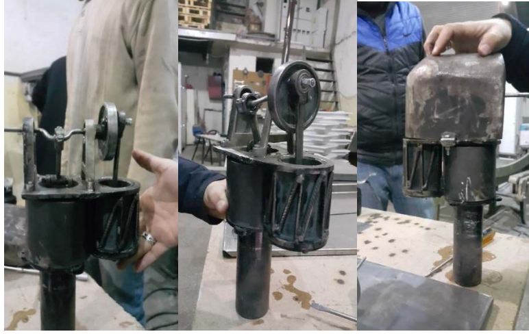
Şekil 4.25. Stirling motorun iç yapısı
