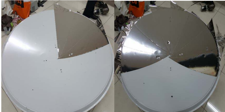
Şekil 4.24. Çanak yansıtıcının folyo ile kaplanması
