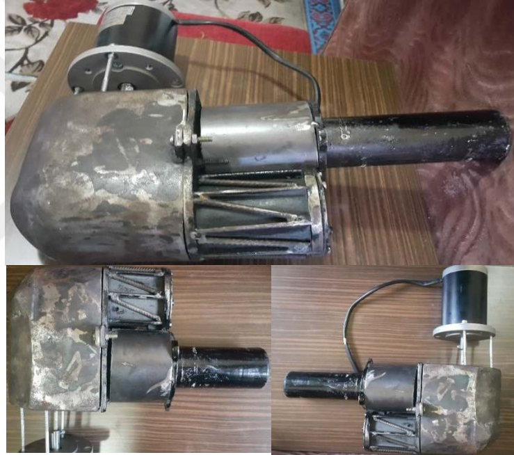
Şekil 4.26. Stirling motorun dış yapısı
