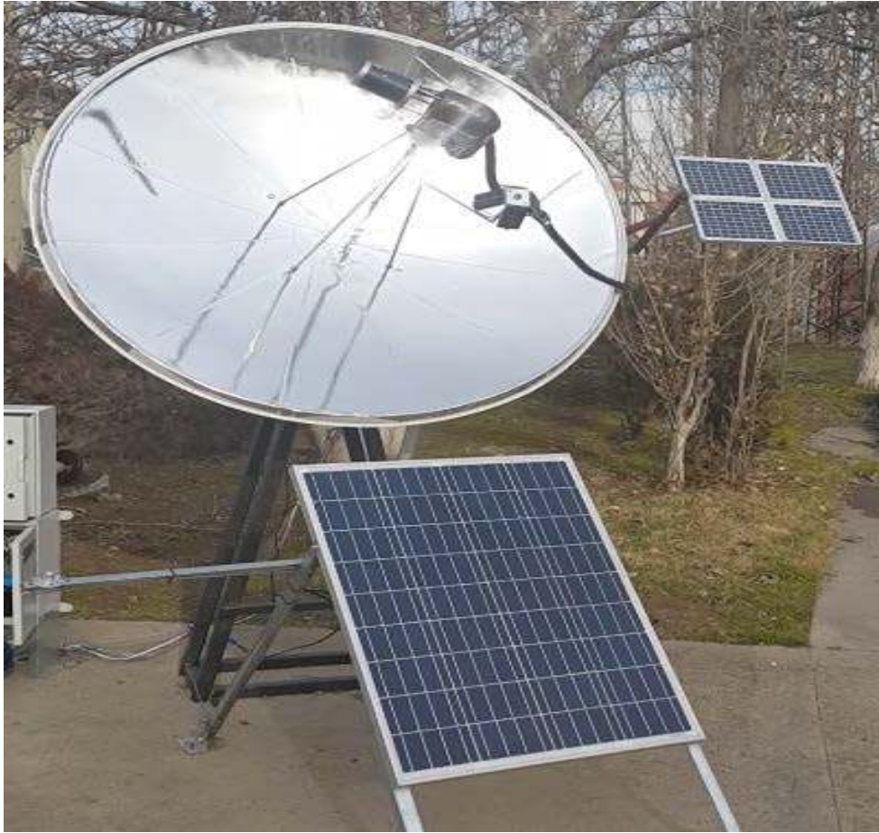
Şekil 8. SMGTS'nin odaklama yapmış hali
