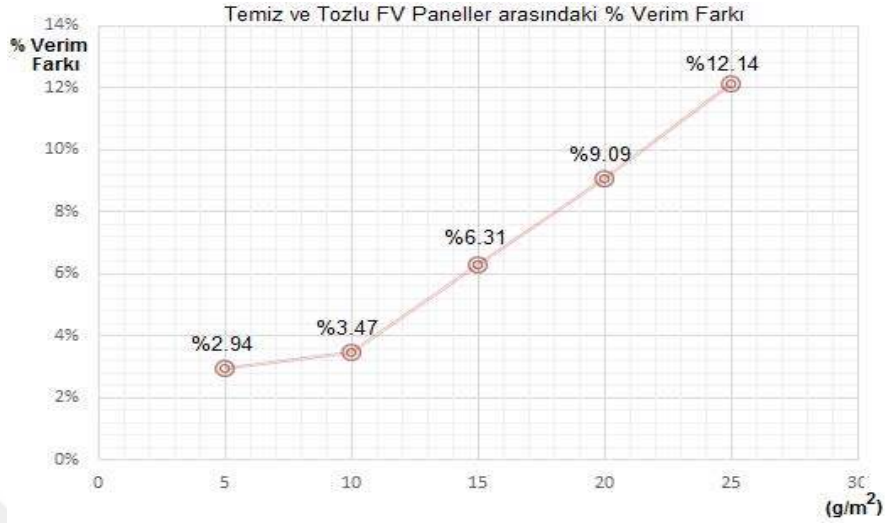
Şekil 5.1. FV panelde tozlanma ve üretilen gücün oransal değişimi
