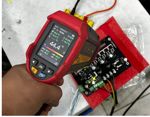
Şekil 7.3. Test esnasında yapılan mosfet sıcaklık ölçümü
