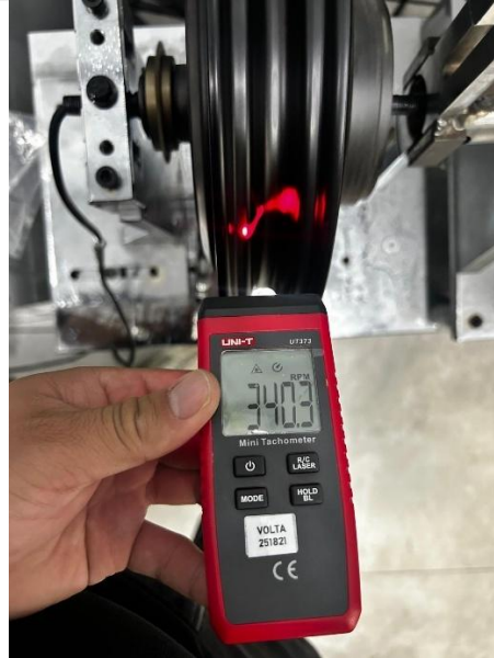
Şekil 7.4 Düşük yük koşullarında yapılan rpm ölçümü
