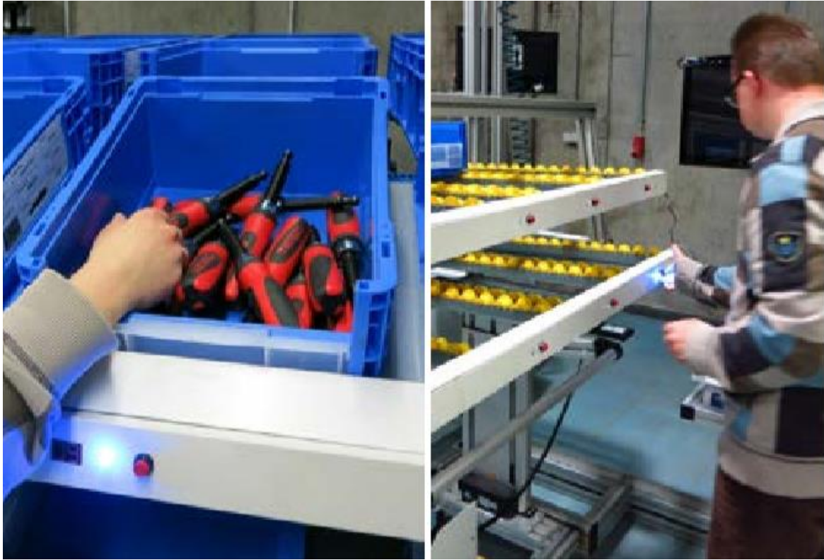
Şekil 15. Işık yardımı ile parça toplama sisteminin deneysel kurulumu
