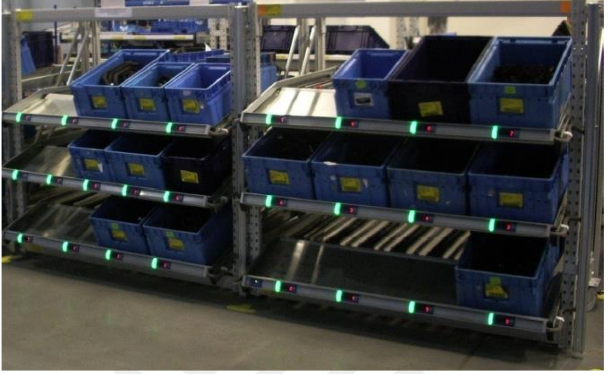
Şekil 22. Işık yardımı ile parça toplama sisteminin devreye alınma görüntüsü
