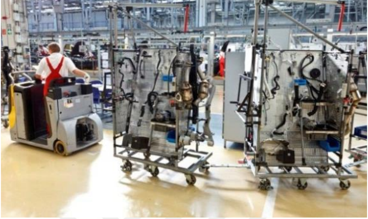
Şekil 11. İhtiyaca göre tasarlanmış kompleks komisyon arabası örneği
