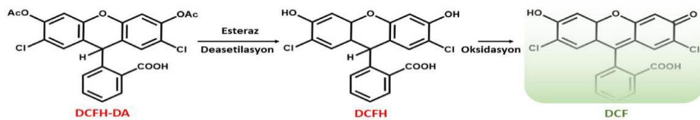
Şekil 4.3. DCFH-DA'nın DCF'ye dönüşüm mekanizması
