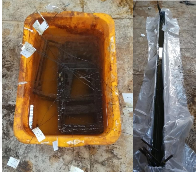
řekil 4.28. Betonarme donatıları hidroklorik asit ile kimyasal temizleme
