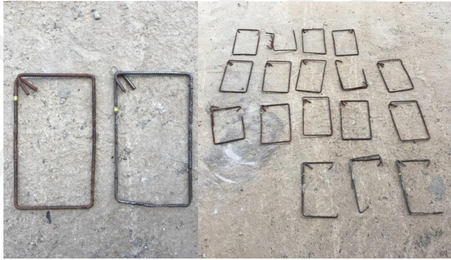
Şekil 4.26. Betonarme kiriş içerisinden çıkarılıp temizlenen çelik etriye donatıları
