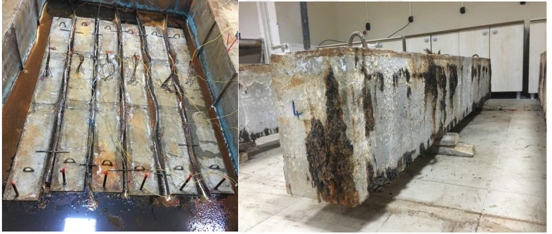
Şekil 4.20. Betonarme kirişlerin hızlandırılmış korozyona tabi tutulması
