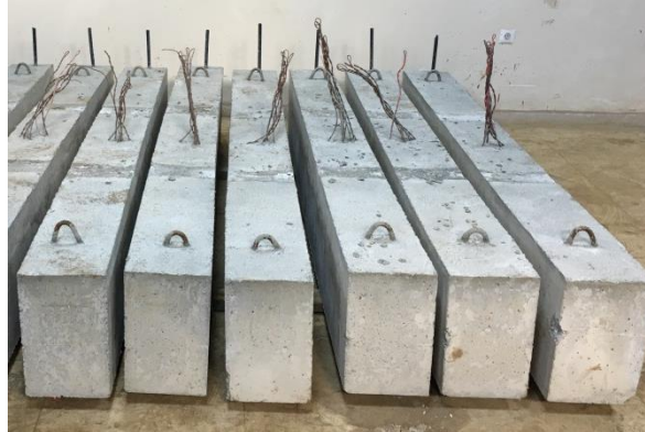
Şekil 4.15. Deney için hazırlanan betonarme numuneler
