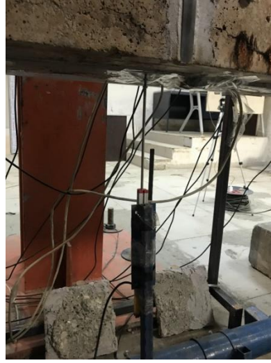
Şekil 4.35. Yük – Yerdeğiştirme için kiriş ortasına yerleştirilen LVDT
