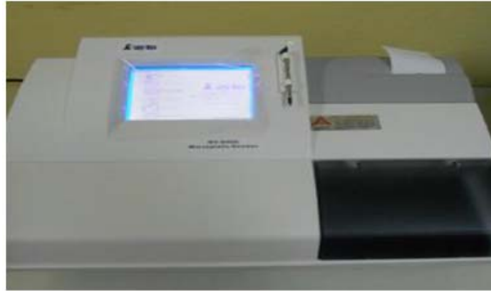
Şekil 3.3. ELİSA mikrotiter plak okuyucu ile adezyon kinetiği analizi
