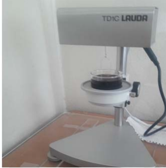
Şekil 3.2. Optik Temas Açısı/Yüzey Gerilimi Ölçüm Cihazı (TD1-CLAUDA) ile Ring metodu
