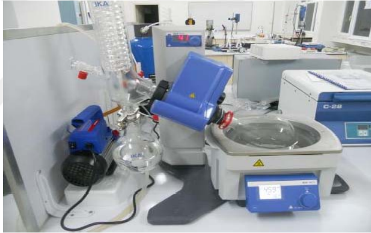
Şekil 3.1. Rotary evaporatör ile biyosüpfektan ekstraksiyonu
