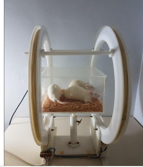
Şekil 3.6 Faraday kafes içerisinde sıçanlara uygulanan pulslu manyetik alan uygulama sisteminin genel görünümü.
