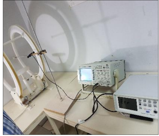
Şekil 3.4 Helmholtz bobinleri arasında ölçülen manyetik alanın şekli (sol) ve manyetik alan ölçüm sisteminin genel görünümü (sağ).
