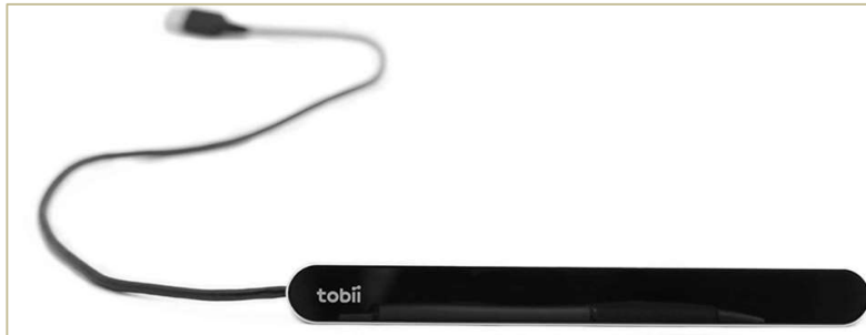
Şekil 3.14. Tobii PCEye mini göz takip cihazı (Tobii Dynavox web sitesi sayfası 2018)
