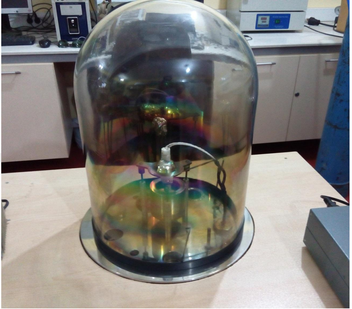
Şekil 2.1. Pireks camından yapılmış vakum kazanı
