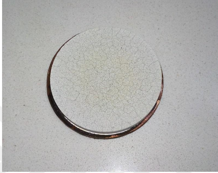
Şekil 3.1. \text{SrF}_2\text{-Ge} hedef malzemesi
