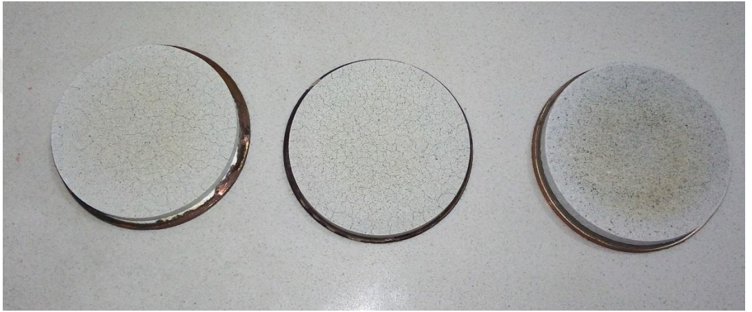
Şekil 4.7. %3, %5 ve %10 oranında germanyum ilave edilen \text{SrF}_2\text{-Ge} hedefleri
