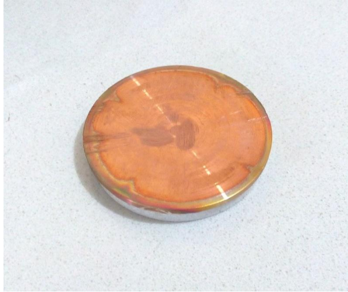
Şekil 3.2. İki inç çapında bakır alt plaka
