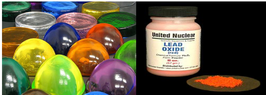
Şekil 1.4. Lead oksit cam (kristal cam) örnekleri
