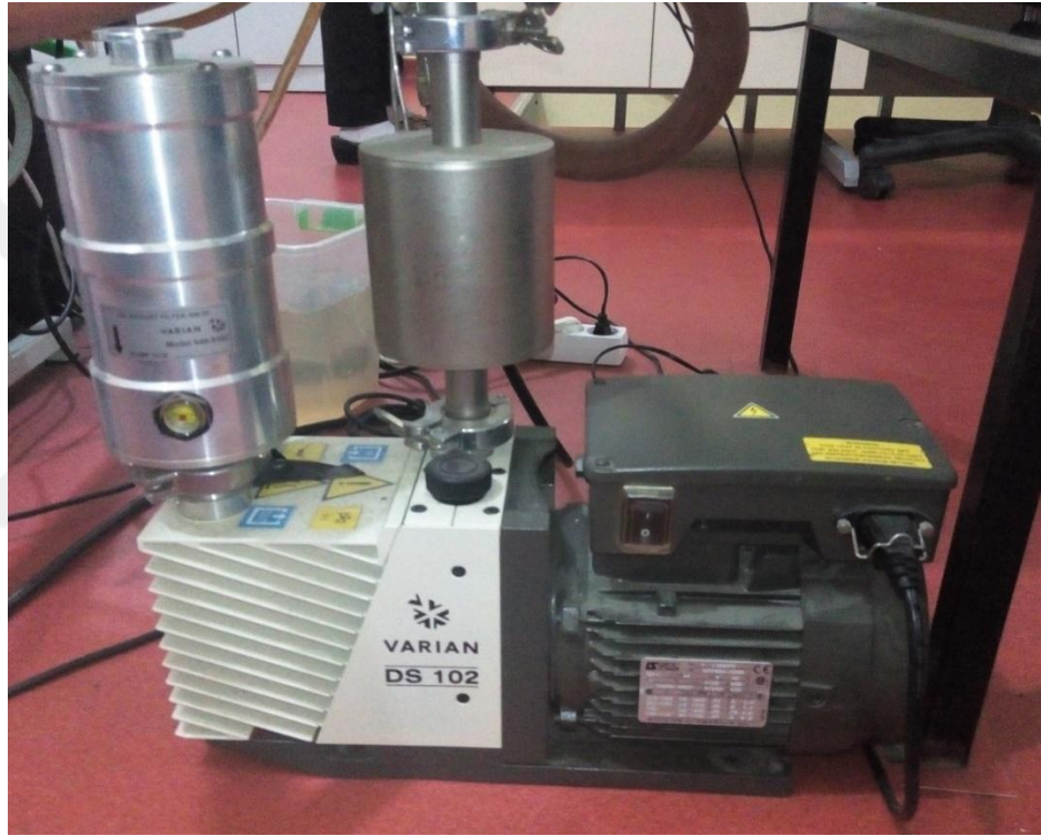
Şekil 3.5. Mekanik pompanın gösterimi
