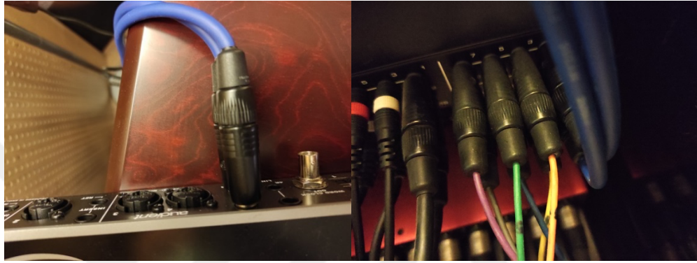
Şekil 51. Ses Arabirim E Giriş Katı Ölçüm Kablolama
