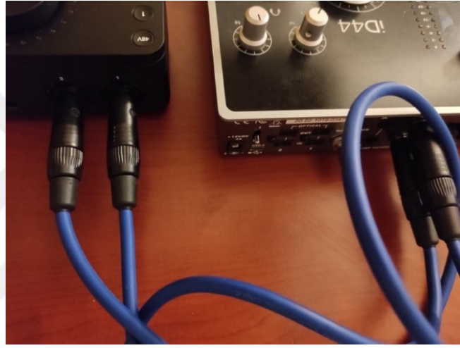
Şekil 27. Ses Arabirim A Giriş Katı Ölçüm Kablolama
