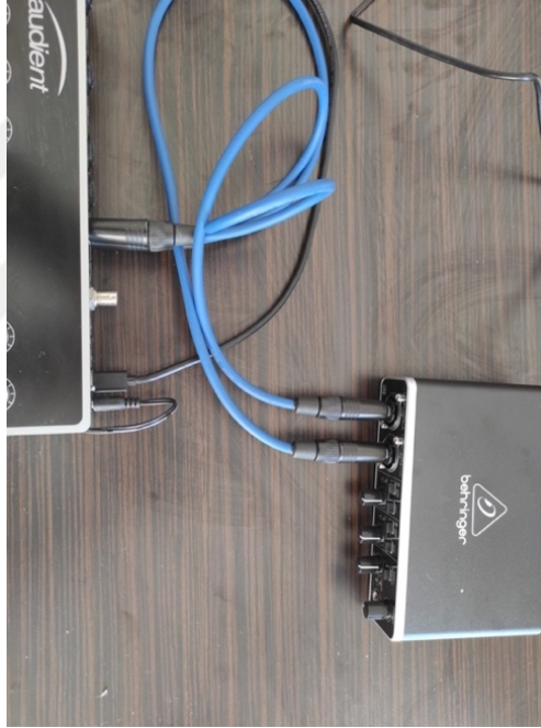
Şekil 39. Ses Arabirim C Giriş Katı Ölçüm Kablolama
