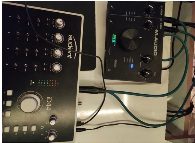
Şekil 33. Ses Arabirim B Giriş Katı Ölçüm Kablolama
