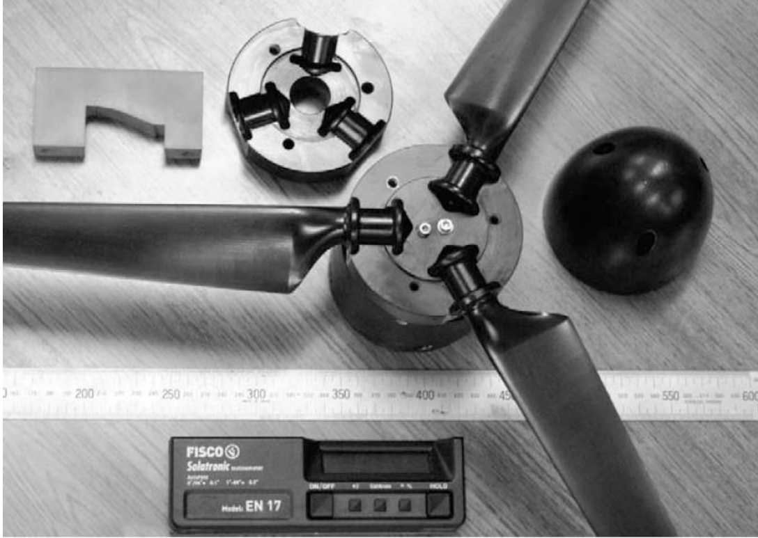
Şekil 5.14 : Türbin modelini oluşturan parçalar (Bahaj ve diğ., 2007b).
