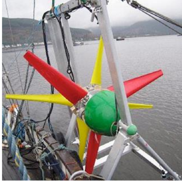
Şekil 1.4 : 2.5m çaplı zıt dönüşlü sualtı akıntı türbini (Xu, 2010).
