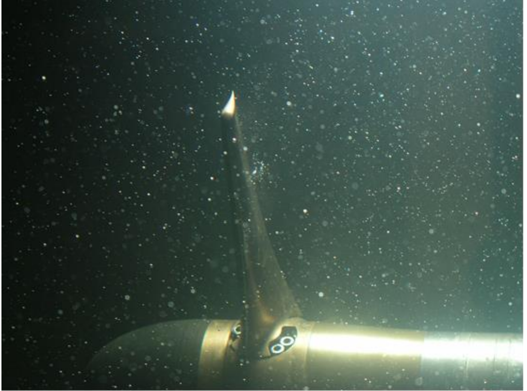
Şekil 3.21 : Ani taşıma kaybı-altı çalışma koşullarında gözlemlenen kararsız bulut kavitasyon.
