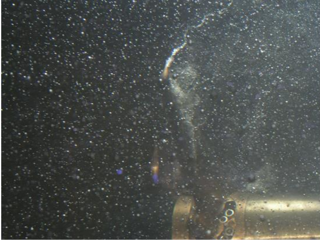
Şekil 3.17 : Ani taşıma kaybı üstü akım hızında kavitasyon oluşumu.
