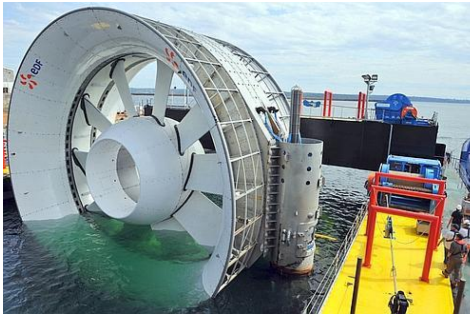
Şekil 1.5 : 16m çaplı nozullu sualtı akıntı türbini (Url-4).
