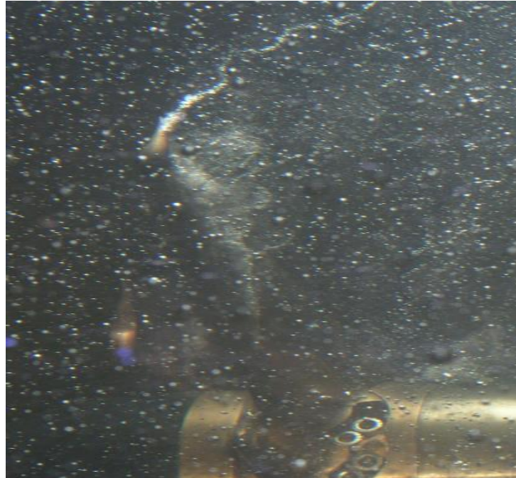
Şekil 5.11 : Kavitasyonun türbin kanatları üzerindeki dağılımı (2.66 m/s serbest akım hızı, \sigma=2.061 kavitasyon sayısı ve TSR=2.7 ).
