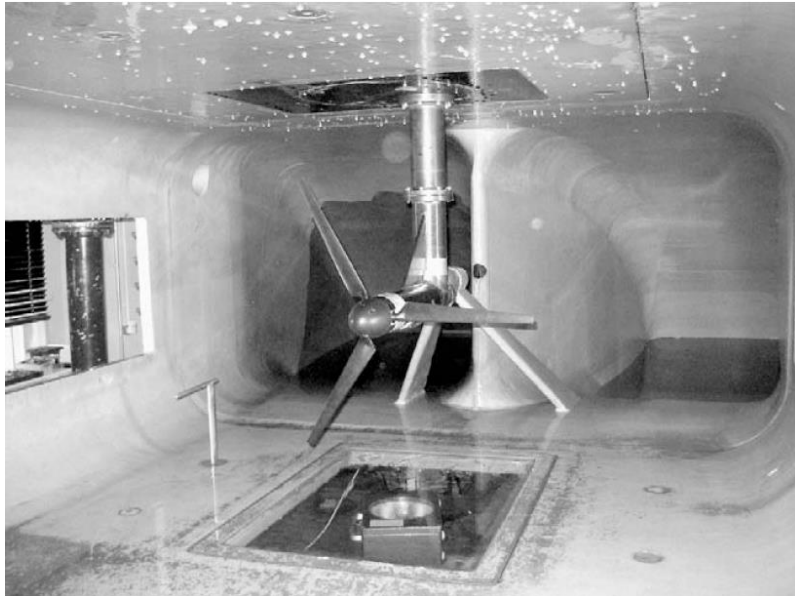
Şekil 5.13 : Türbin modelinin kavitasyon tüneli içerisindeki yerleşimi (Bahaj ve diğ, 2007b).
