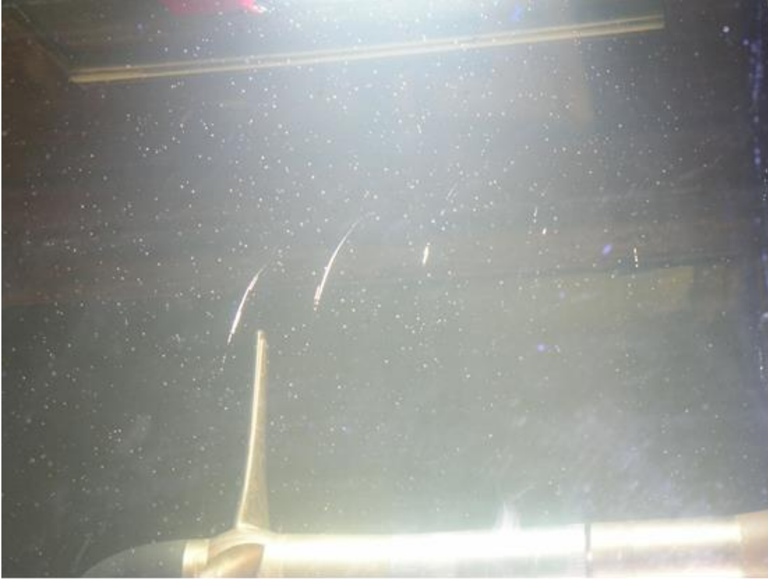
Şekil 3.19: Ani taşıma kaybı-altı çalışma koşullarında gözlemlenen çok zayıf uç girdapları.
