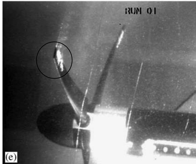
Şekil 5.17 : 1.4 m/s serbest akım hızı, 0.64 kavitasyon sayısı ve TSR=7.5 için kavitasyon dağılımı (Bahaj ve diğ, 2007b).
