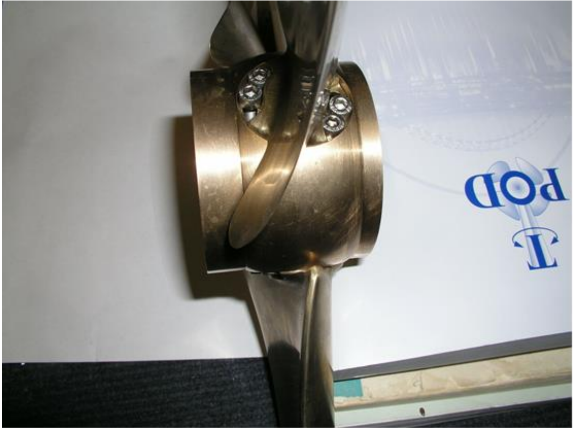
Şekil 3.9 : Ayarlanabilir hatve açılı kanatlar (0 – 25 derece).
