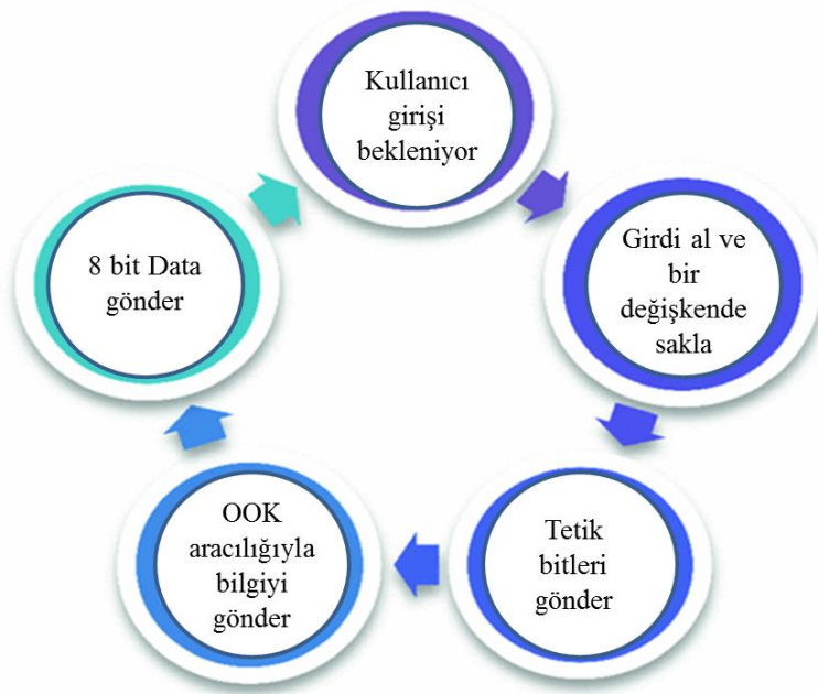
Şekil 3. 8. İletim mekanizmasının akış şeması
