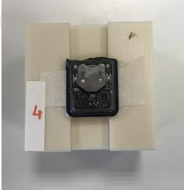
Şekil 4. 3. Verici ölçümlerinde kullanılan Bosch SCD sensör
