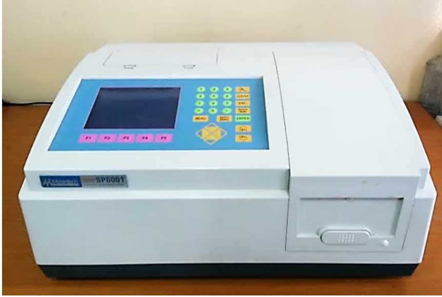
Şekil 3.9. UV-Vis (Metertech SP8001) spektrofotometresinin görüntüsü
