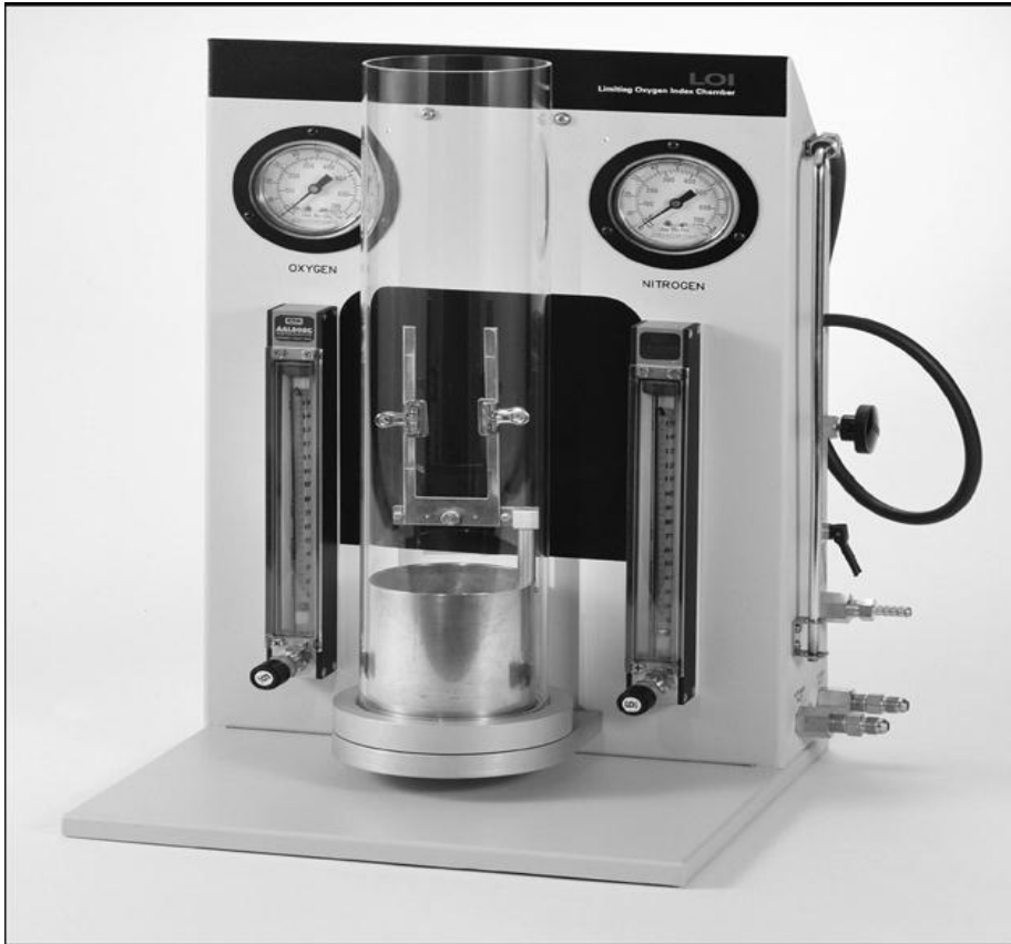
Resim 4.1. LOI test cihazı
