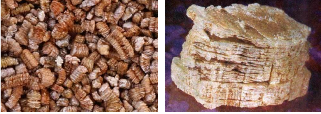
Şekil 2.6. Genleştirilmiş vermikülitin tipik şekli [48]
